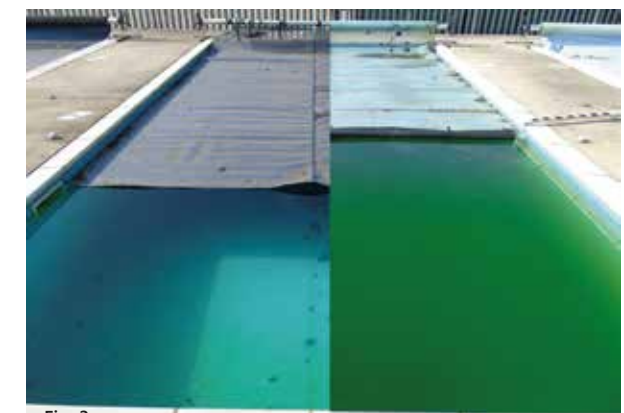
Fig. 3 Das obige zusammengesetzte Bild (Fig. 3) zeigt Pools, die während der Winterperiode mit EnergyGuard™ Selective Transmission (L) und einer transparenten Abdeckung (R) bedeckt sind.
